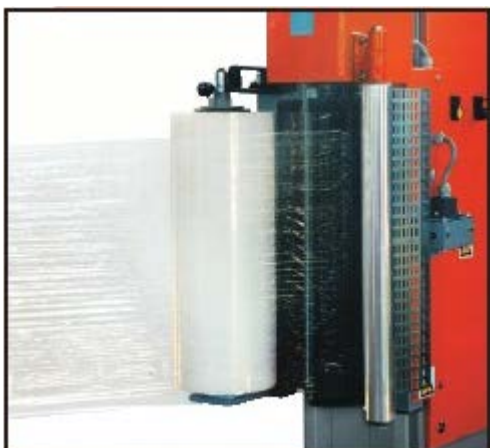
Dispozitiv CP670/A (opțional) pentru preîntindere motorizată a filmului 200% (1m=3m)
