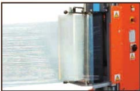
Cuplaj electromagnetic pentru reglarea tensiunii filmului (standard)
